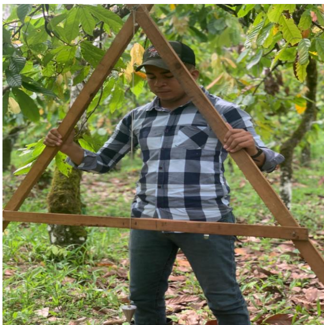
Figura 10. Medición para determinar la pendiente en el área de cacao.
