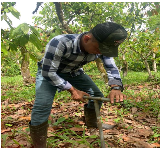
Figura 9. Uso del barreno para determinar la profundidad efectiva del suelo.
