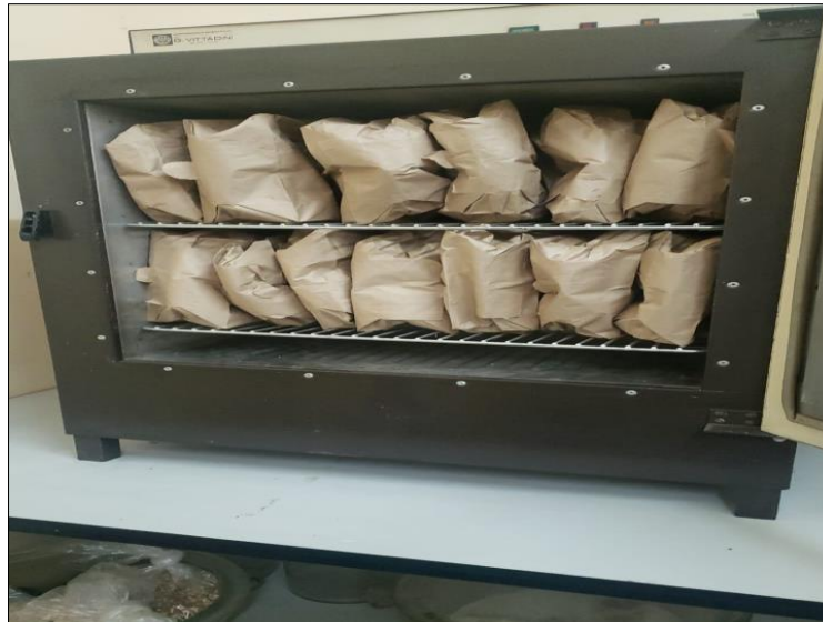
Anexo 10 Secado en hornos industriales a °65 c.
