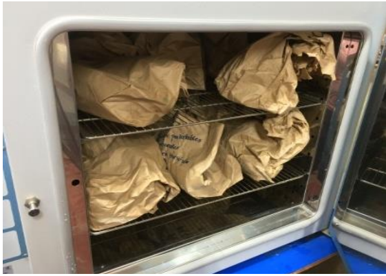
Anexo 10. Proceso de secado de las muestras del Pseudotallo, plántulas de plátano variedad CEMSA \frac{3}{4} , en horno de aire forzado a 65°C por 72 h
