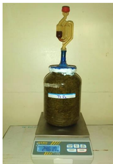
Figura 8. Pesaje individual de cada microsilo, según tratamiento y repetición.
