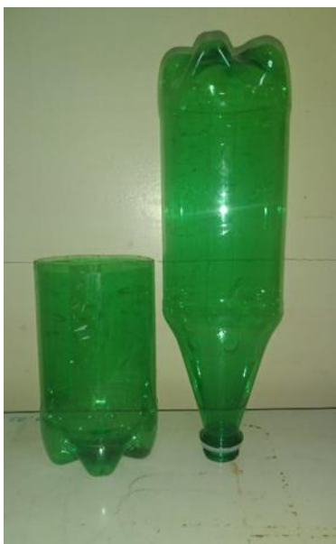
Figura 9. Instrumento diseñado con botellas de tereftalato de polietileno (PET) para la evaluación de la estabilidad aeróbica del ensilaje.
