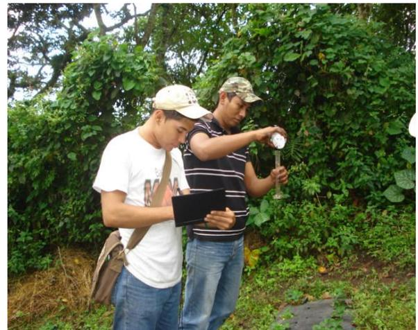
**Anexo 12** Aforación de goteros y medición del gasto del emisor, utilizando una probeta de 100 ml.
