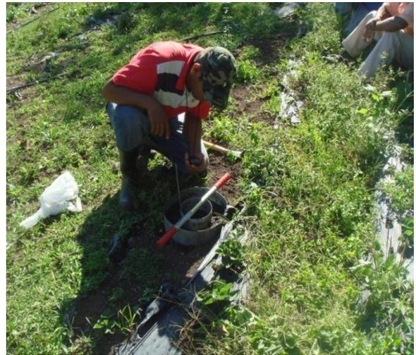
**Anexo 9.** Prueba de infiltración con el doble cilindro en las áreas experimentales El Castillito, Las Sabana, Madriz.
