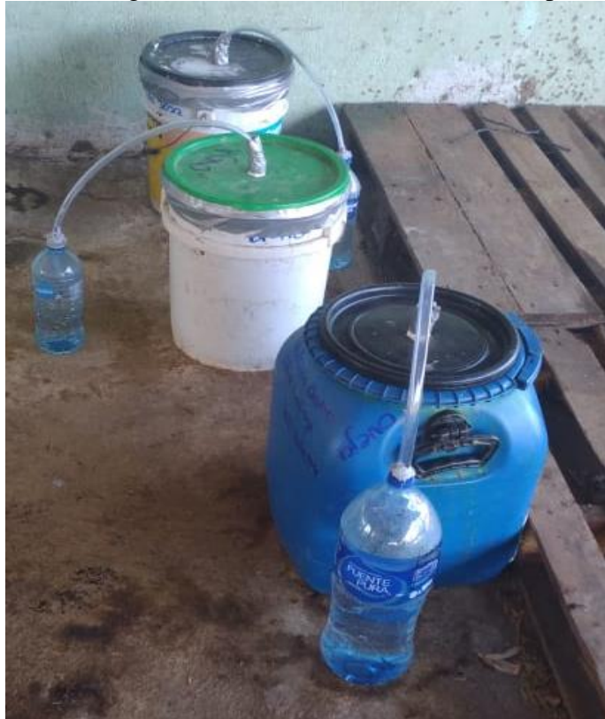
Anexo 6: Biodigestores en funcionamiento con trampa de agua
