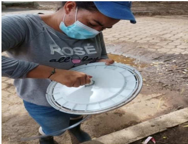
Anexo 2: Ensamble del adaptador macho de ½ pulgada en la tapa e inserción de manguera de ½ pulgada con 75 cm de largo y sellado con silicón industrial
