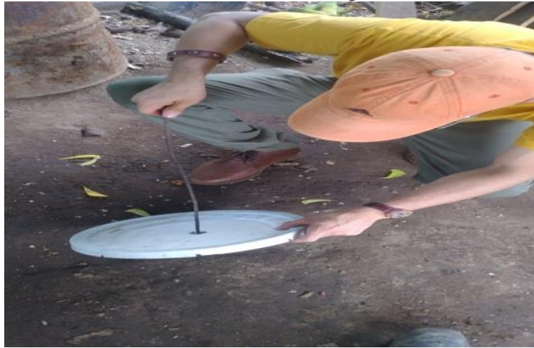
Anexo 2: Ensamble del adaptador macho de ½ pulgada en la tapa e inserción de manguera de ½ pulgada con 75 cm de largo y sellado con silicón industrial
