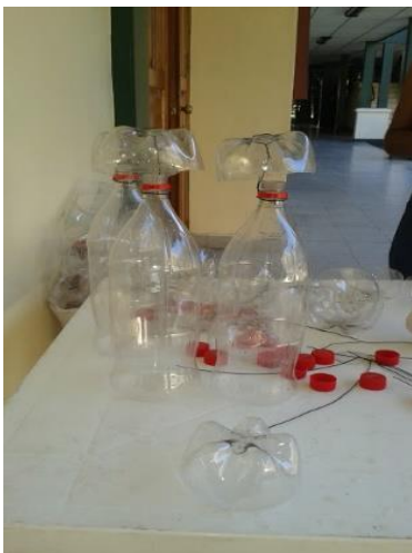
Anexo 4. Cámara captadora de amoníaco
