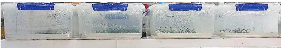
Figura 3. Modelo de biorreactor BIMOT empleado para estudio de densidad de siembra con 70, 80, 90 y 100 tejidos de piña cv. MD-2 en la fase de multiplicación.
