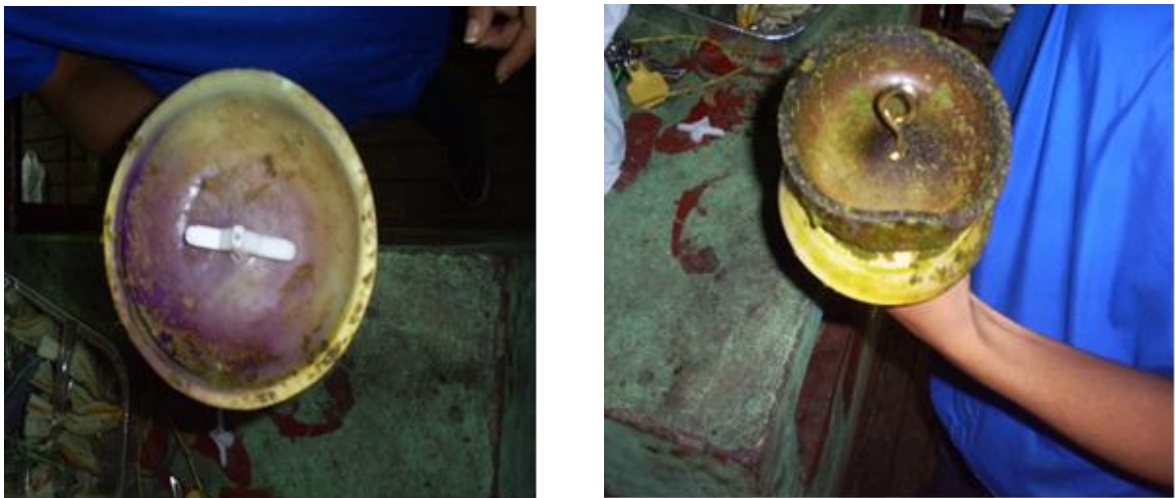
Figura 4. Vista superior e inferior del tapón de la cánula con la armella fijada.
