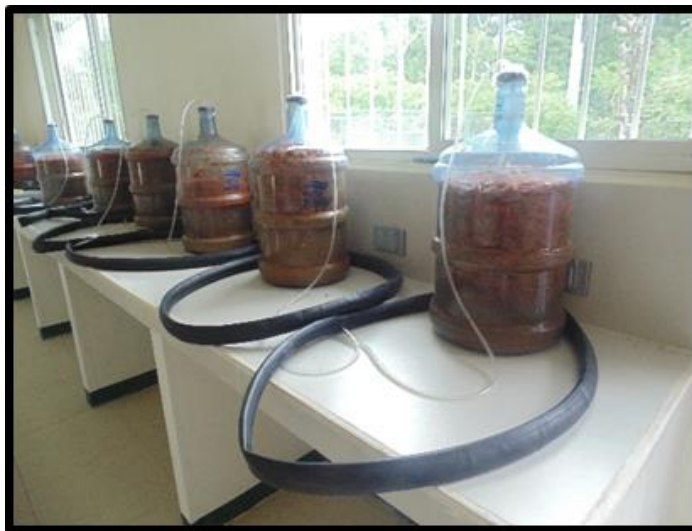
Figura 2. Ensayos a escala de laboratorio de cutícula y cabeza de camarón
