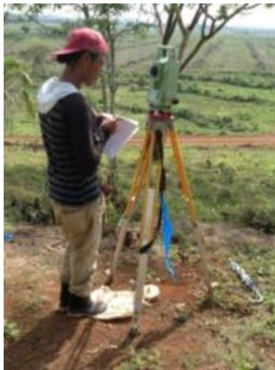
**Figura 8.** Localización del vértice de drenaje utilizando la estación total
