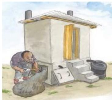
figura 9. Letrina abonera de secado solar. Figura 10. Letrina de cierre hidráulico
