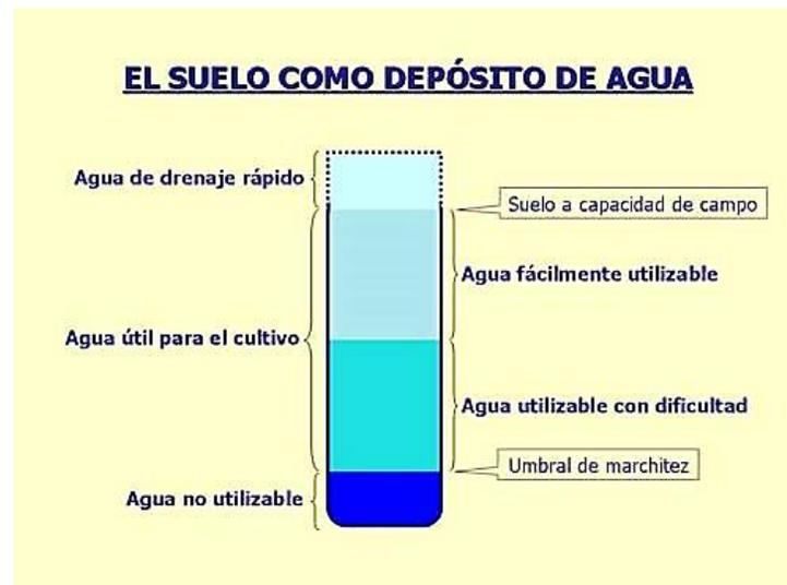
Figura 16. Esquema de Distribución de Agua a medida que disminuye la humedad en el suelo.
