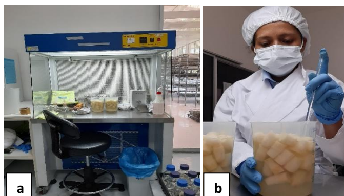
Figura 10. a) Cámara de flujo laminar en área de transferencia de tejidos; b) desinfección de explantes de plátano con cloro al 1% más tween 20 en cámara de flujo laminar.
