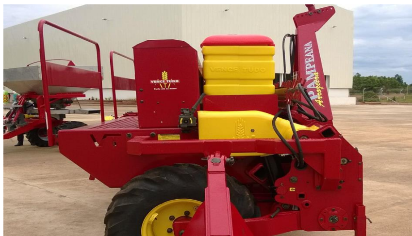
Figura 6. Distribución de Semilla y Abono, Sembradora Vence Tutto. Agrícola Miramontes, Boaco, julio 2019
