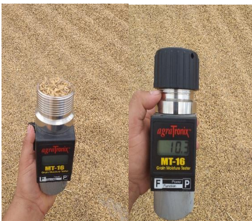
Figura 23. Medición de humedad con un tester
