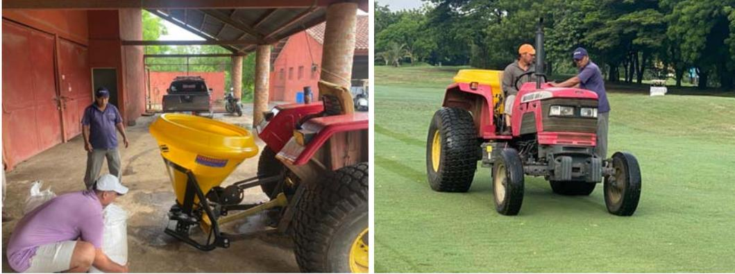
Figura 5. Abonadora utilizada para la fertilización de campo de golf
