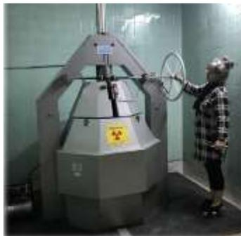
Figura 3. Irradiador isogamma LL-Co con fuente de Cobalto 60 ( $\text{Co}^{60}$ ) utilizado para la irradiación en masa de vitroplantas de malanga Lila y Blanca en el centro Nacional de Estudios Aplicados a la Energía Nuclear
