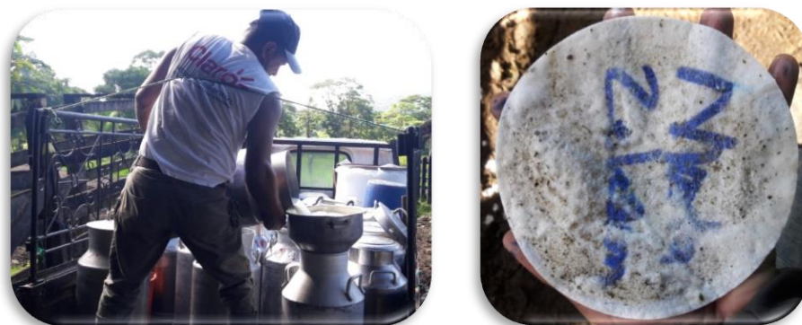
Fotografía 13. Pruebas de filtrado o sedimento en rutas.
