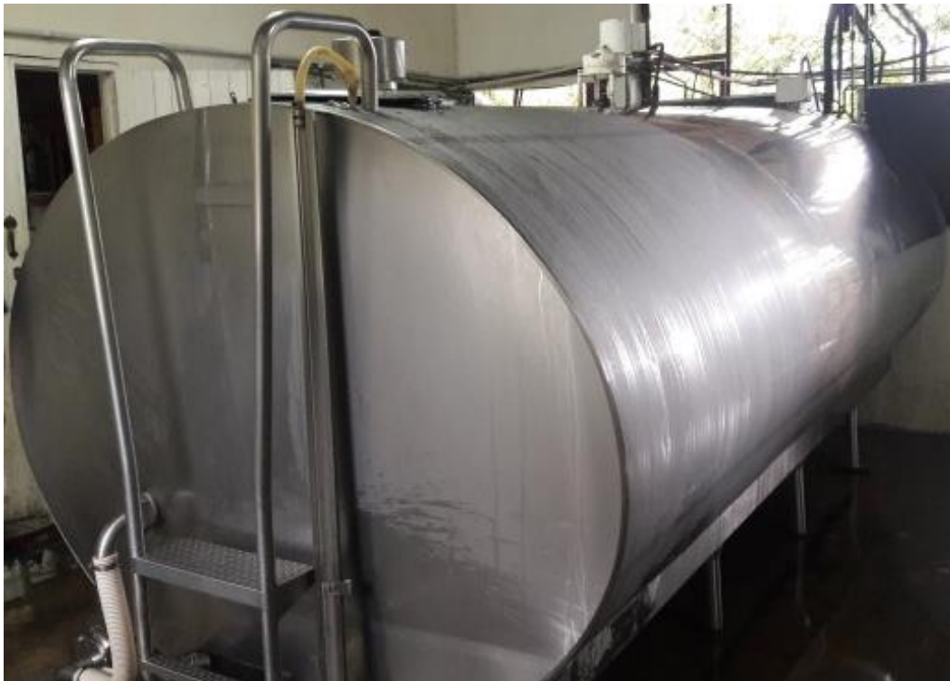
Anexo 16. Tanque frio (capacidad 8,000 litros)
