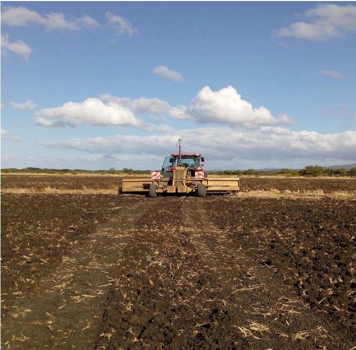
Anexo 15. Figura 14 CASE 260 trabajando en nivelación GPS.
