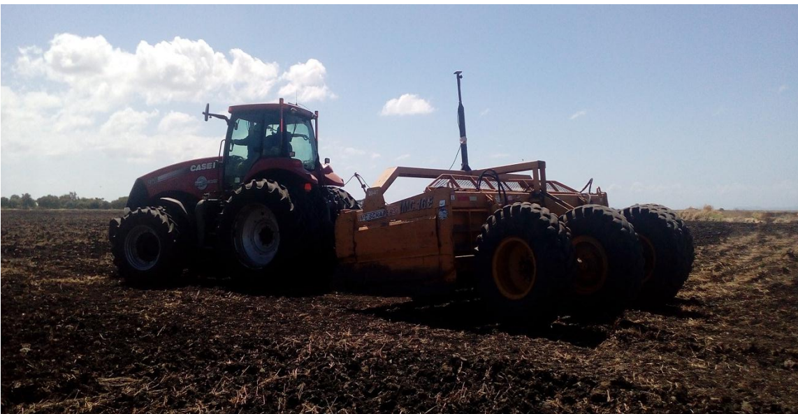
Anexo 15. Figura 14 CASE 260 trabajando en nivelación GPS.
