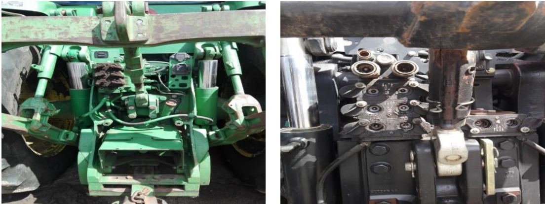
Figura 2 Bloque de válvulas hidráulicas CASE 260 (izquierda) y JOHN DEERE 8430 (derecha)
