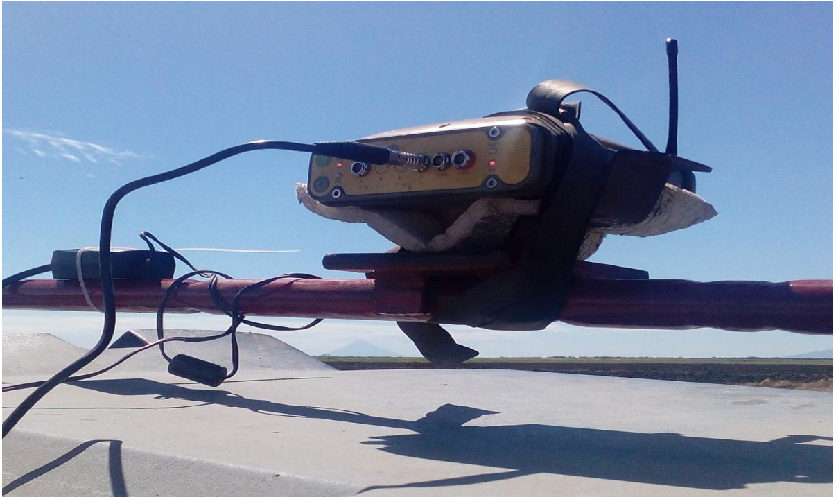
Anexo 13. Figura 12 Hiper AG Rover, levantamiento topográfico
