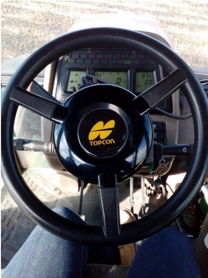
Anexo 6. Figura 5 Piloto Automático instalado en CASE 150 para dirección Automática.
