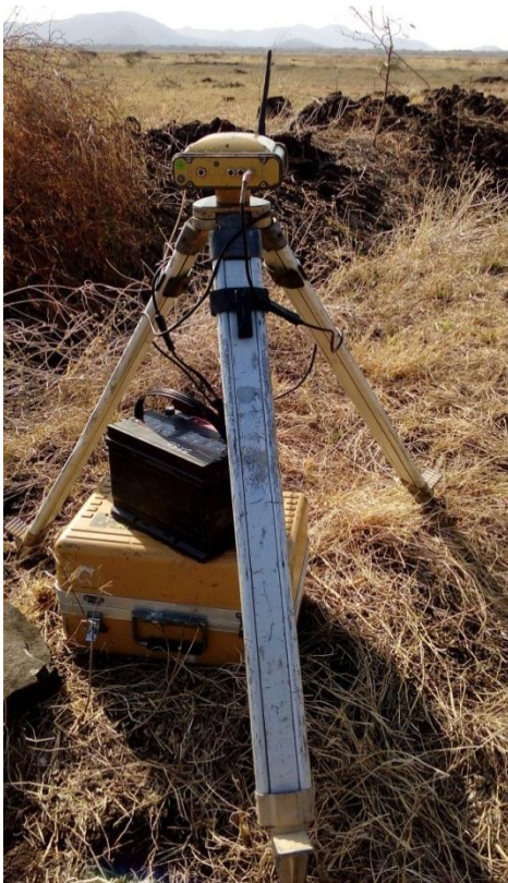
Anexo 17. Figura 16 Estación Base Hiper AG
