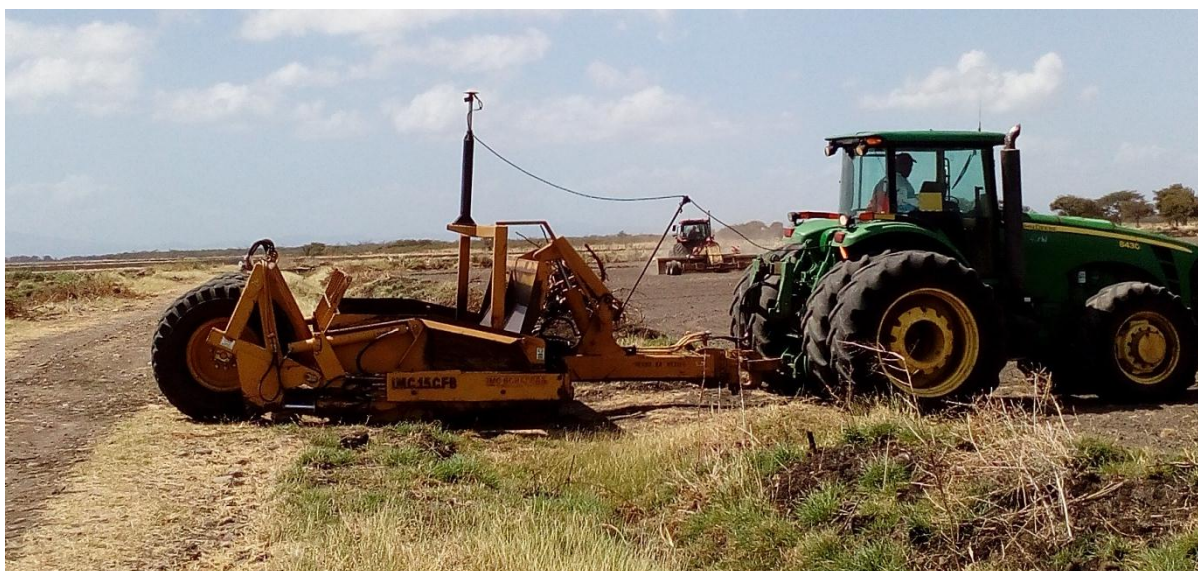
Anexo 19. Figura 18 John Deere 8430 con trailla IMC scraper amarrándose en el BM para entrar al lote a nivelar con GPS
