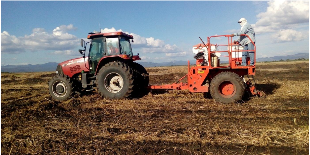
Anexo 4. Figura 3 Siembra directa de arroz con dirección automática.
