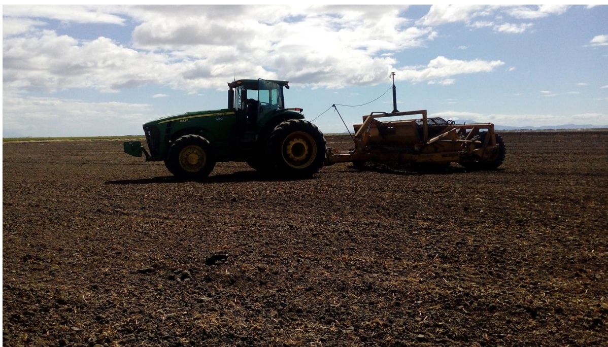
Anexo 19. Figura 18 John Deere 8430 con trailla IMC scraper amarrándose en el BM para entrar al lote a nivelar con GPS
