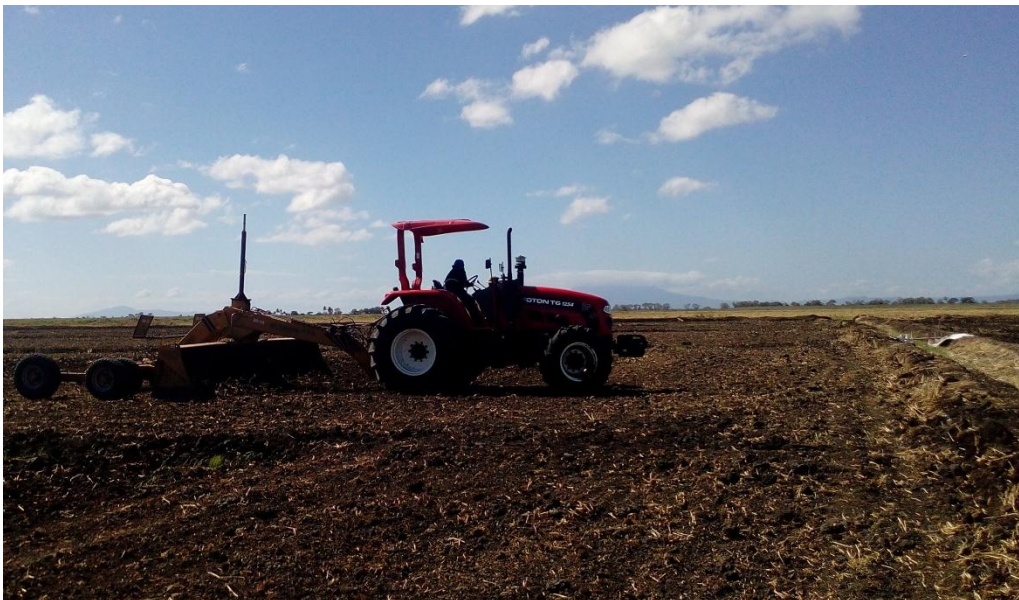
Anexo 9. Figura 8 FOTON 1254 TG trabajando en nivelación convencional.
