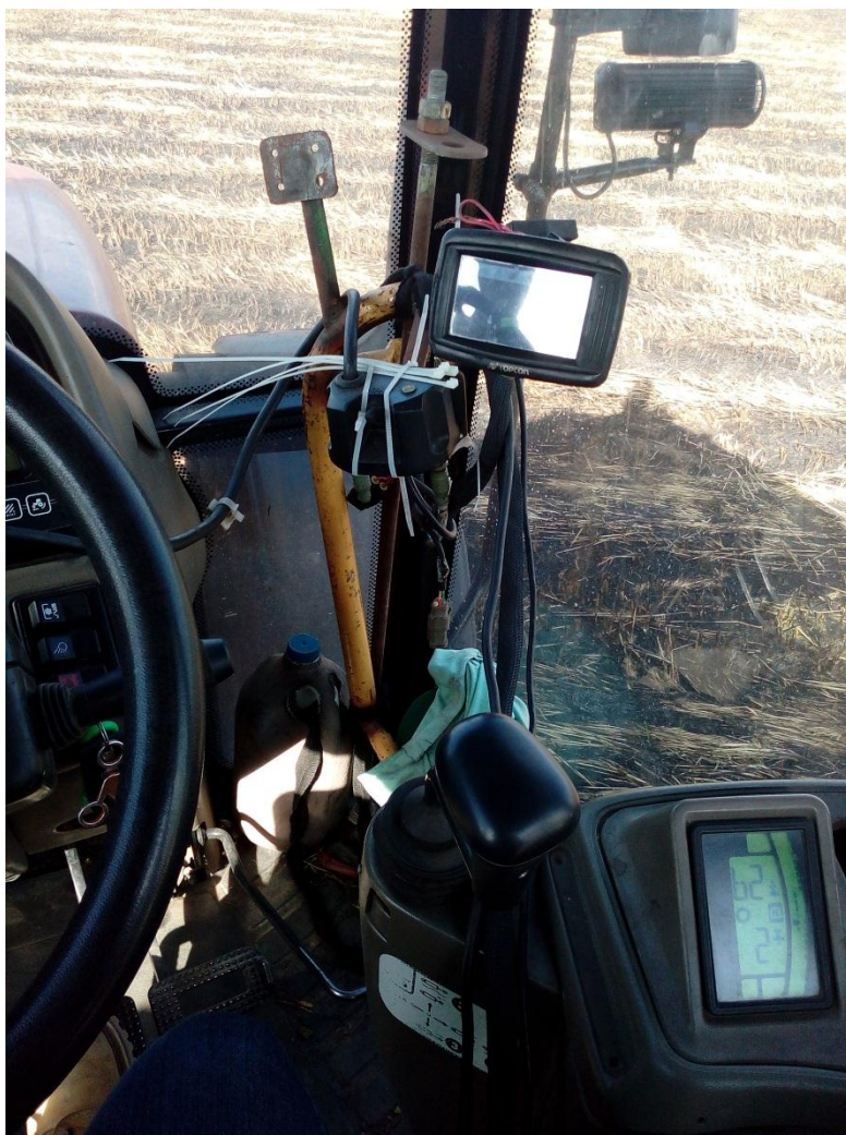
Anexo 7. Figura 6 Consola X14 instalada en CASE 150 para guía Automática en siembra de arroz.
