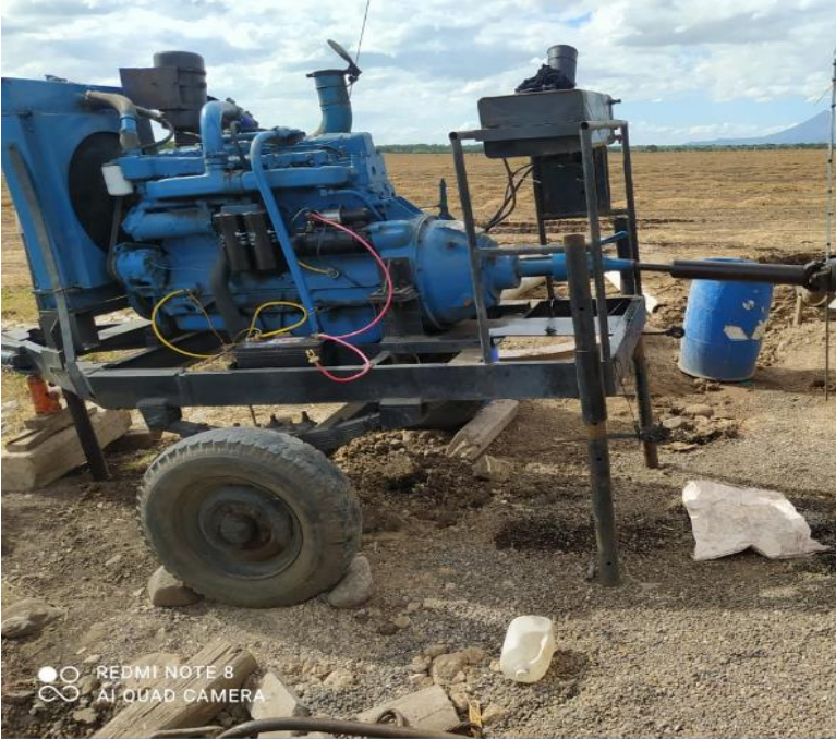
Figura 17. Motor de prueba de bombeo.
