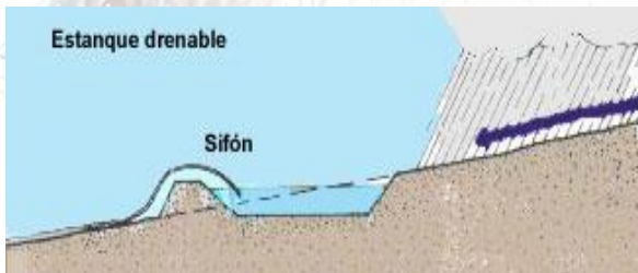
Figura 22. Estanque drenable. Fuente FAO, s.f.
