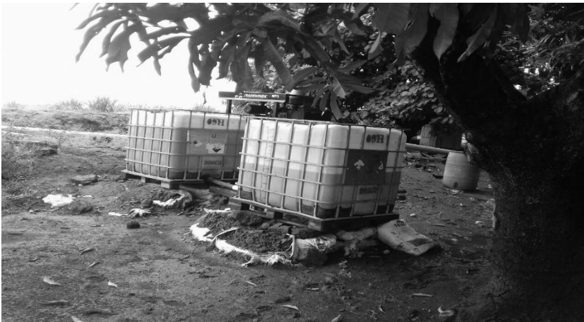
Imagen 9 almacenamiento del combustible.
