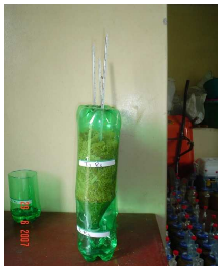
Figura 5. Sistema de determinación de la estabilidad aeróbica
