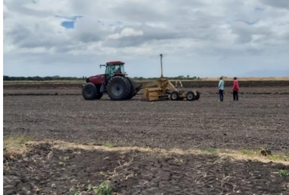
Fig. 6 Tractor modelo Case 150 controlado la nivelación GPS
