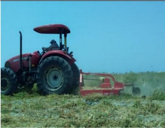
Fig. 4 Chapodadora convencional modelo Rotter 180 TC
