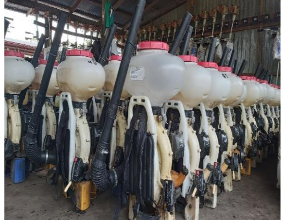
Fig. 3 Motobomba MARUYAMA con diámetro de boquilla del tubo de 2`1/4.
