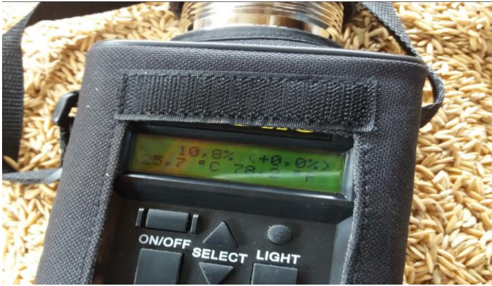
Figura 1 Instrumento que sirve para determinar humedad del grano
